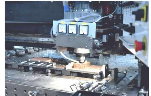
Восстановление фрагмента плиты методом сварки трением с перемешиванием
