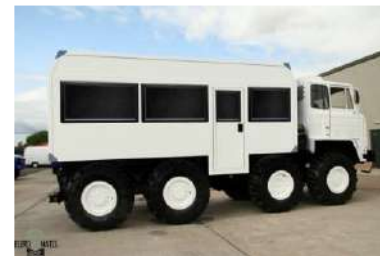
Макетный образец «арктического» автобуса «Урал» проходит исследовательские испытания на территории Якутии.
